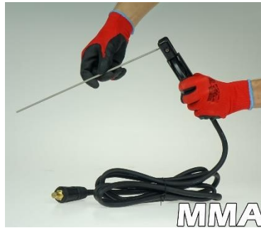
Rys. 7. Zdjęcia podglądowe metody MMA
