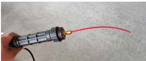
Rys. 9. Teflonowa osłona drutu aluminiowego w uchwycie spawalniczym MIG
