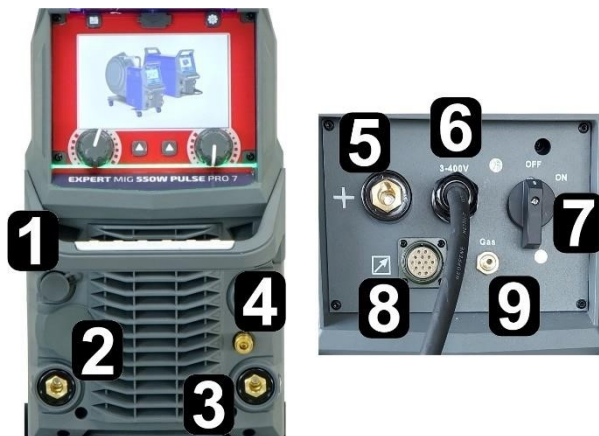
Rys. 2. Przód i tył źródła spawalniczego
