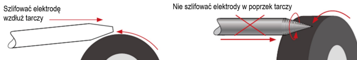
Rys. 24. Szlifowanie elektrody wolframowej
