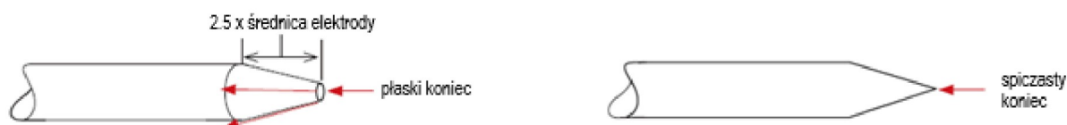
Rys. 25. Kształt elektrody wolframowej
