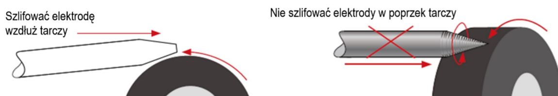
Rys. 16. Szlifowanie elektrody wolframowej
